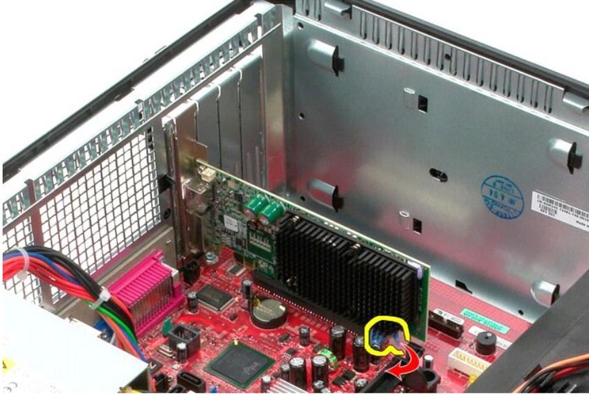
4. Levante la tarjeta de expansión y sáquela de la ranura de expansión.
