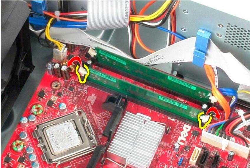
3. Levante el módulo de memoria y sáquelo del conector de la placa base y extráigalo del equipo.
