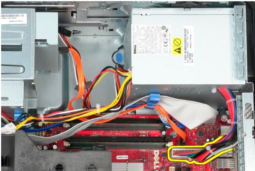
7. Retire el cable de datos del panel de E/S del gancho de cableado en la base de la fuente de alimentación.
