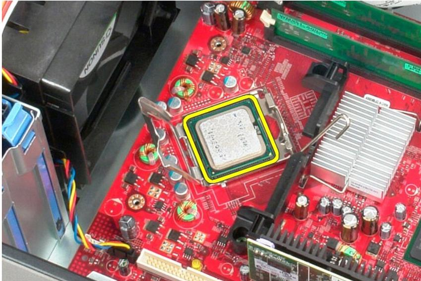
△ **PRECAUCIÓN:** cuando coloque el procesador, no toque ninguna de las patas que se encuentran dentro del zócalo ni deje que caiga ningún objeto en las patas del zócalo.
