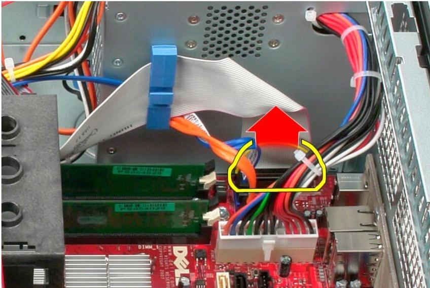
3. Retire el cable de datos de E/S del gancho de cableado.
