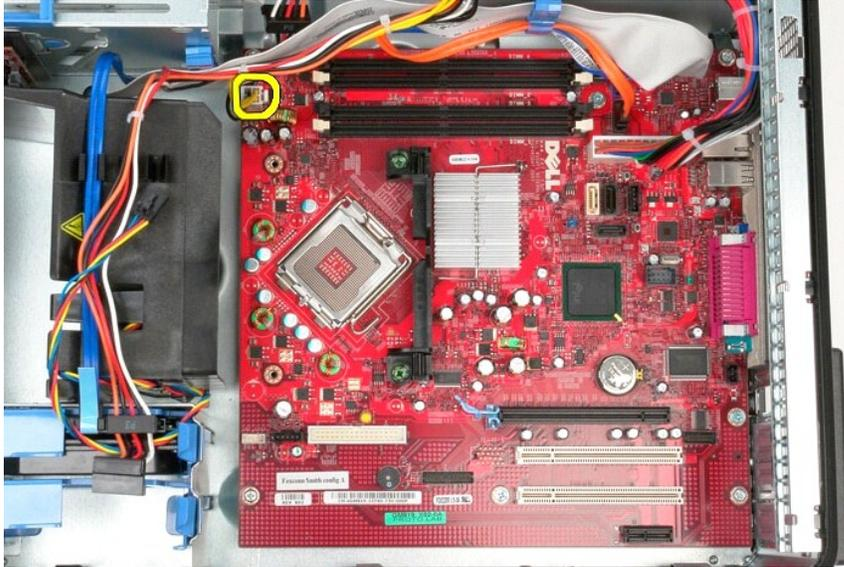
7. Desconecte el cable de alimentación de la placa base.
