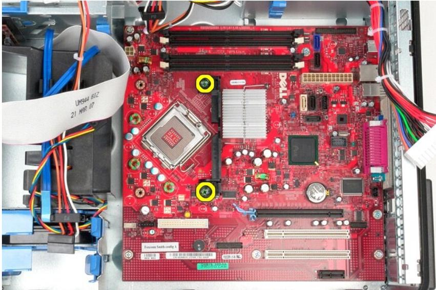
12. Quite el soporte del ensamblaje del disipador de calor del equipo.
