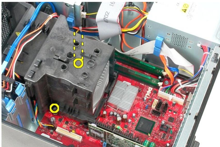
3. Gire el disipador de calor hacia la parte posterior del equipo y sáquelo.
