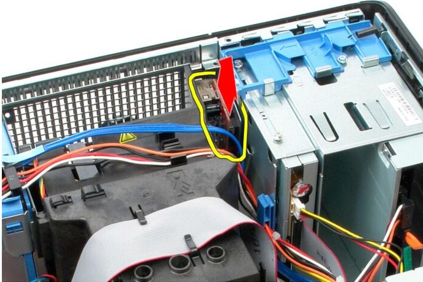
8. Desconecte el cable de datos del panel de E/S.
