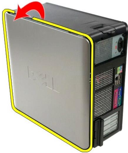
4. Retire la cubierta del equipo.
