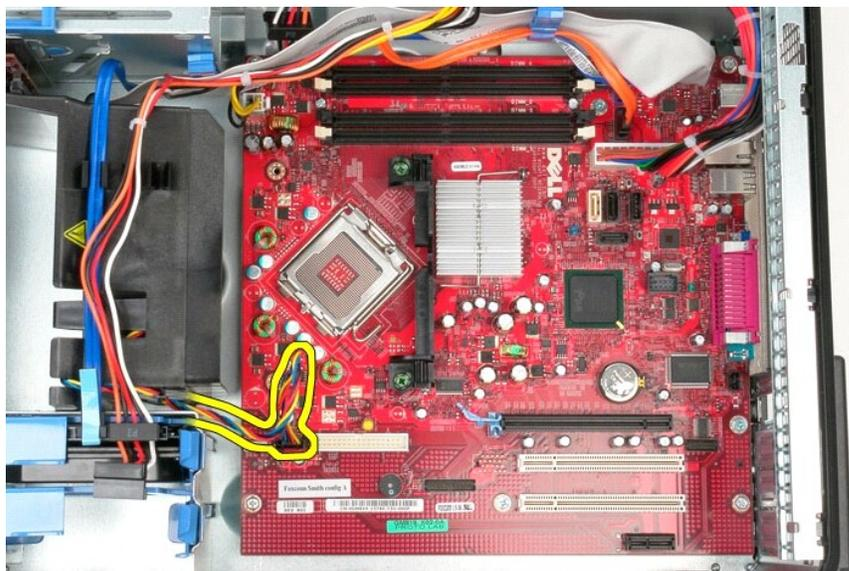
6. Desconecte el cable de alimentación del procesador de la placa base.
