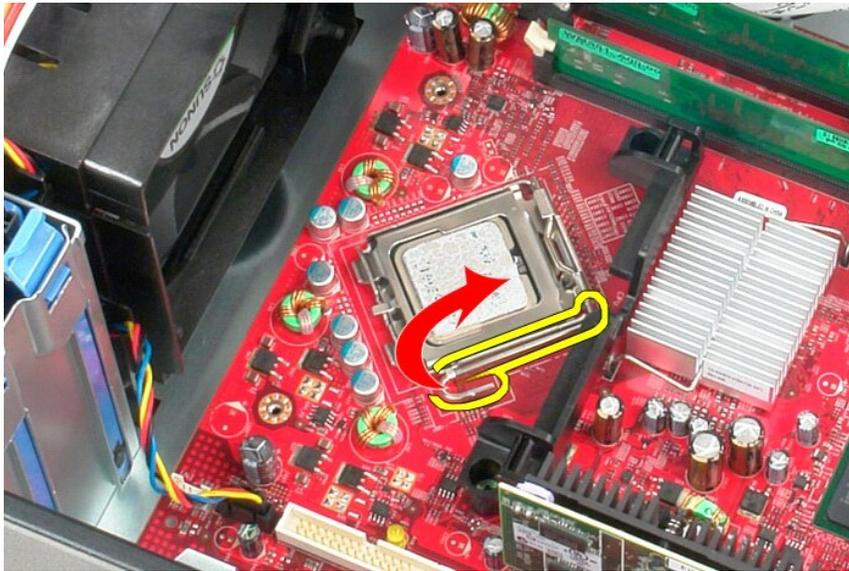
3. Levante la cubierta del procesador.
