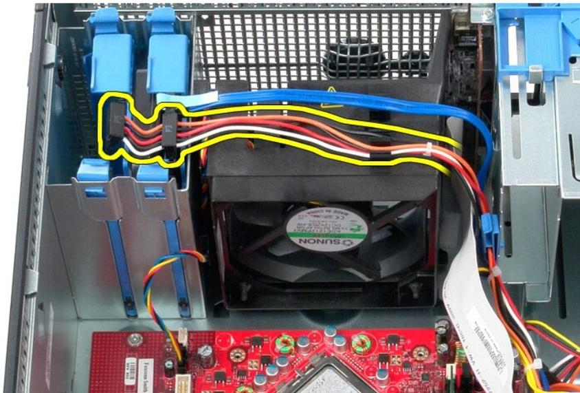
3. Desconecte el cable de datos de la unidad de disco duro.
