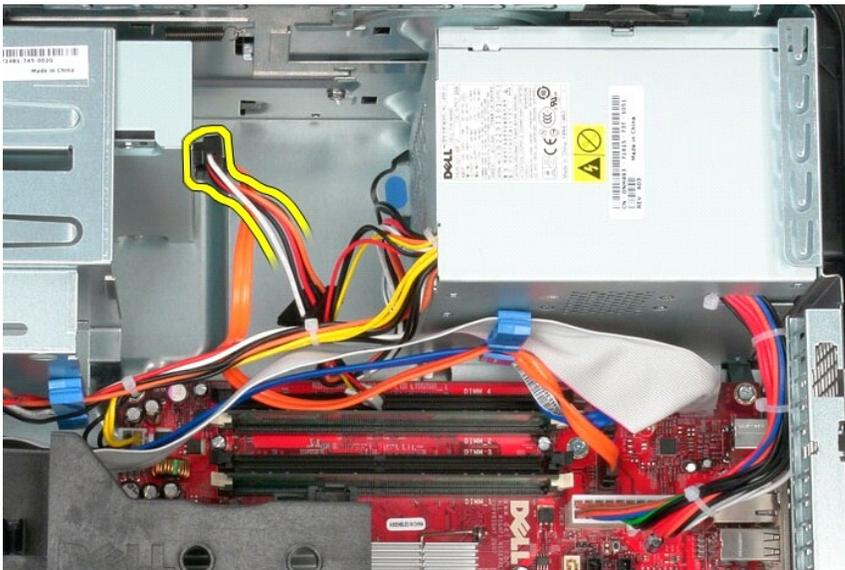
5. Desconecte el cable de alimentación del procesador de la placa base.
