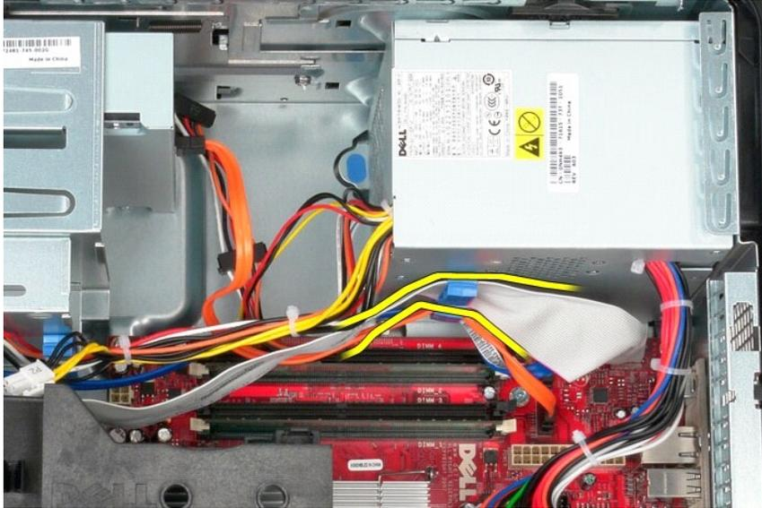
8. Extraiga cualquier cable de datos de la guía de cables de la base de la fuente de alimentación.
