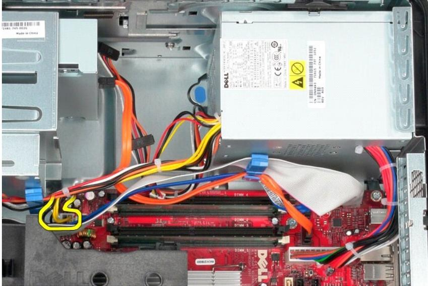
6. Desconecte el cable de alimentación de la placa base.
