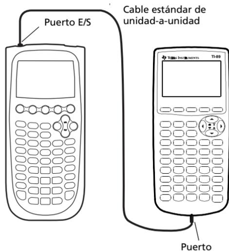
*Una calculadora TI-89 Titanium y una TI-89 conectadas entre sí*
