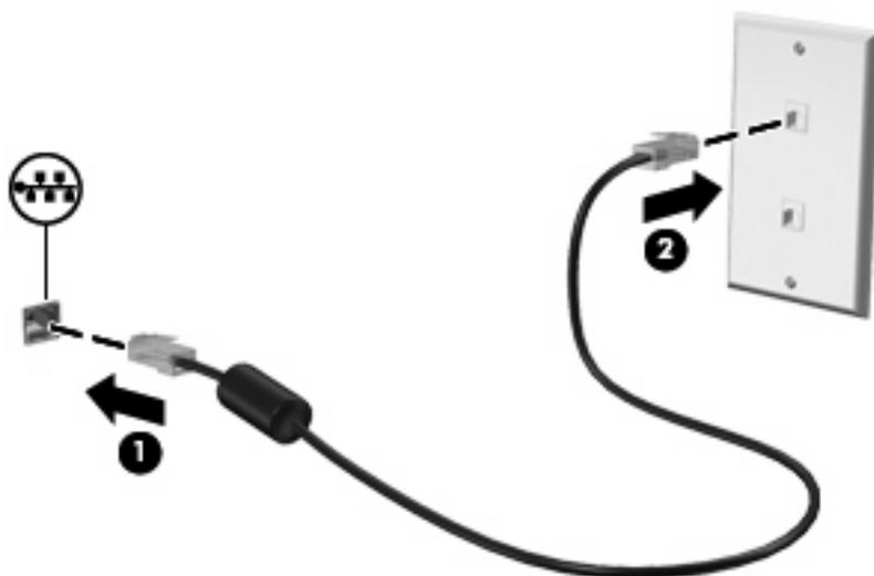
**⚠ ¡ADVERTENCIA!** Para reducir el riesgo de que se produzca una descarga eléctrica, un incendio o daños al equipo, no conecte el cable de módem o del teléfono a un conector RJ-45 (de red).
