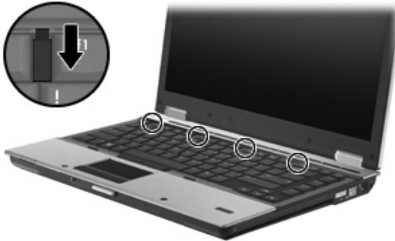
10. Levante el borde superior del teclado suavemente e incline el teclado hasta que se apoye en el apoya muñecas del equipo.
