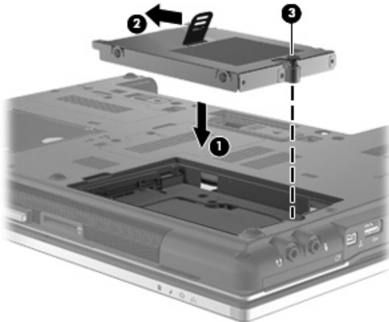
4. Alinee las pestañas (1) de la cubierta de la unidad de disco duro con las muescas del equipo.
