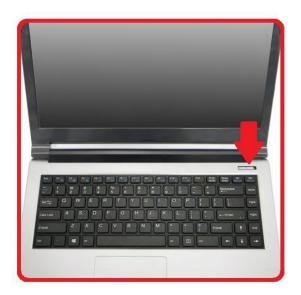
Encienda su ordenador con oprimir el interruptor. Sosténgalo por un par de segundos. Corre el Auto Test del Encendido (Power-On Self Test (POST)) automáticamente. Después de completar el POST, el ordenador lee el sistema operativo de la unidad rígida en la memoria del ordenador (comúnmente referido como "booting" de un ordenador). Si su SO (Sistema Operativo como Windows 7 y/o Windows 8) está instalado, debe iniciarse automáticamente.
