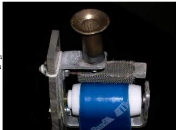
La esfera o cúpula superior metálica debe tener estas características: ser de forma esférica y tener los bordes en que termina el hueco interno doblados hacia el interior.
