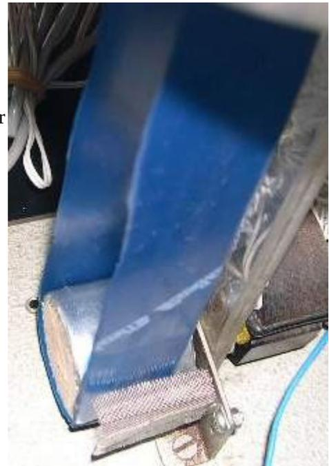
El rodillo superior de teflón, al entrar en contacto con la correa y separarse, se carga negativamente, e induce en las puntas del peine situadas más allá de la correa un aumento del campo eléctrico añadido al de las puntas
