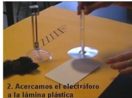
Si tocamos con un dedo la superficie metálica superior del electróforo, como nuestro cuerpo es un gran condensador, atrapamos todas las cargas negativas y sólo quedan las positivas en el electróforo.
