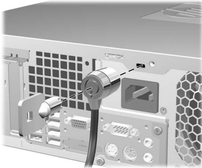
Figura C-1 Instalación de un candado con cadena
