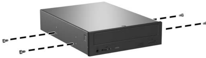
Figura 2-26 Instalación de tornillos de guía en la unidad óptica
