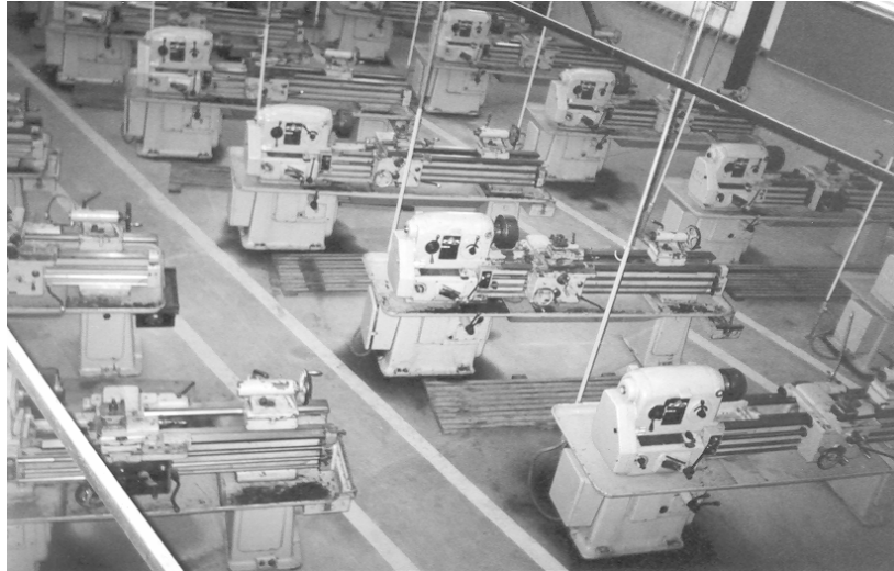
Figura 2.2 Tornos impulsados por motores eléctricos de C.A.
